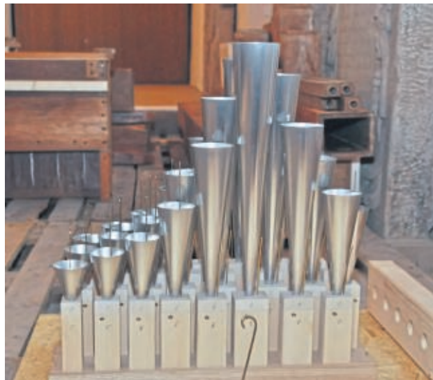
Werden zunächst im Kirchenschiff gelagert: Die insgesamt über 2000 Orgelpfeifen sind aus einer speziellen Zink- und Bleilegierung hergestellt.
